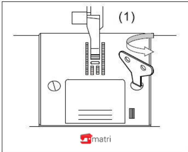
Nehmen Sie die Spulenkapsel heraus (2) und entfernen Sie mit einer Bürste Staub und Fadenreste, auch unter die Spulenkapsel.
