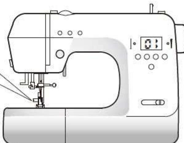
Si utiliza un prensatelas para cremalleras puede elegir el prensatelas de la derecha o de la izquierda (mire 1 y 2). Tendrá que elegir la puntada correcta.
