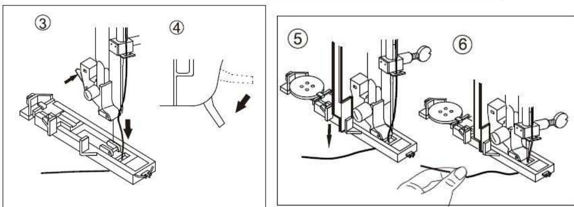
I passaggi da seguire per cucire un'asola sono spiegati nel manuale d'istruzione.
