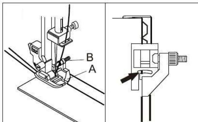
Con el tornillo (B) puede ajustar la guía (A). Al coser, la puntada debería coincidir con la flecha en la tela doblada.
