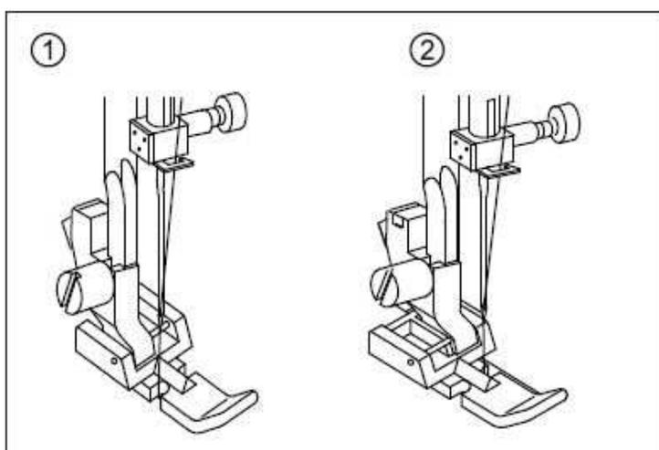
Si utiliza un prensatelas para cremalleras puede elegir el prensatelas de la derecha o de la izquierda (mire 1 y 2). Tendrá que elegir la puntada correcta.
