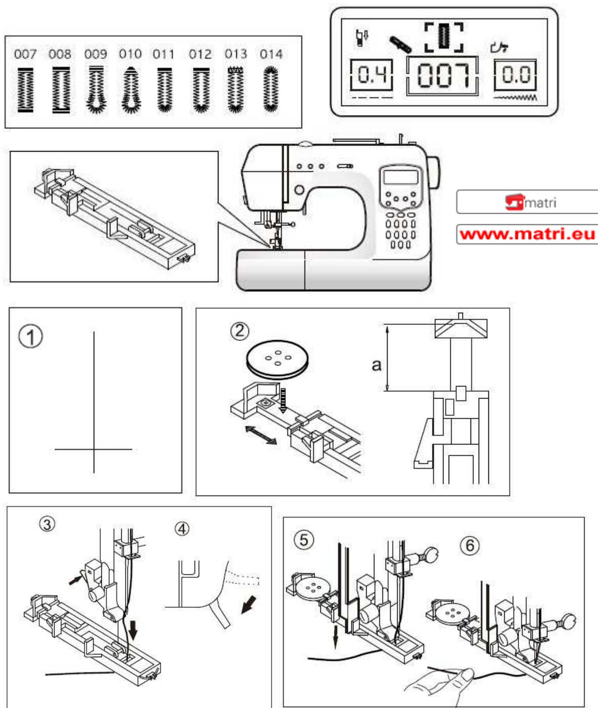
I passaggi da seguire per cucire un'asola sono spiegati nel manuale d'istruzione.
